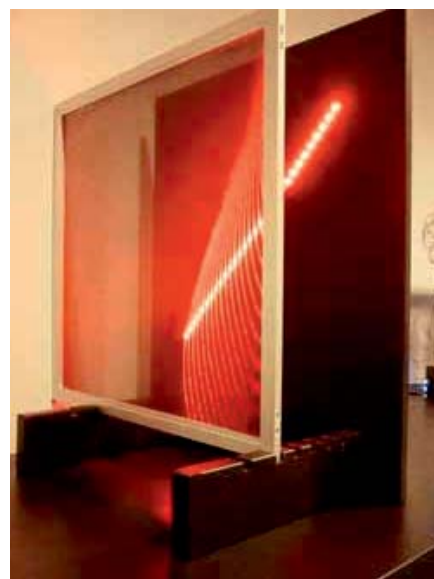
ilustración 2. Ejemplo de montaje: marco soporte, tela optica Fabriled, LEDs y soporte panel posterior
